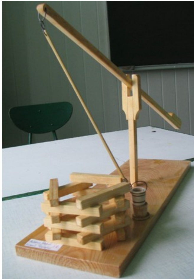
Żuraw studzienny, przykład maszyny prostej Praca wykonana przez Milenę Dąbek i Kamila Partykę, uczniów kl. II b.
